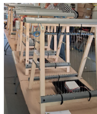
Fig. Exemple d'harpes électriques fait-main
